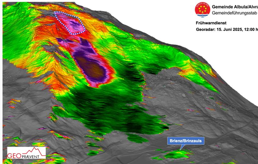
Bild des Georadars vom Sonntagmittag: Blau-weiss markiert das "Plateau Ost". Etwas tiefer (braun) die "Schutthalde oben".
