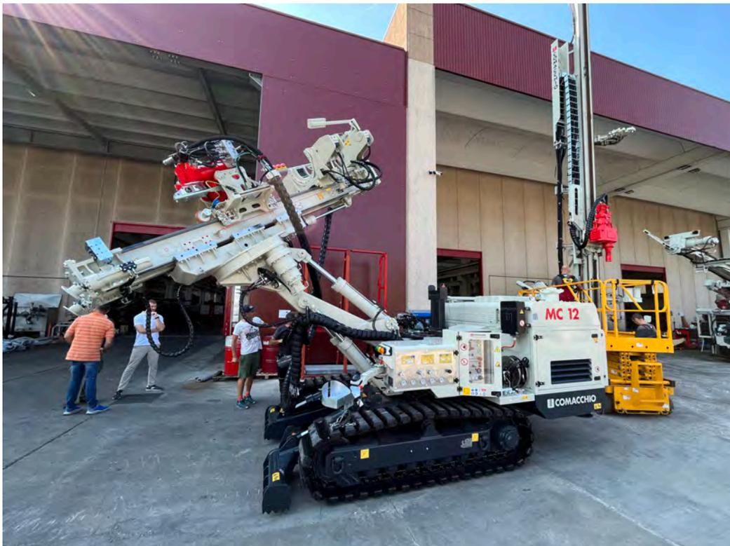
*Die neue Bohrmaschine für den Entwässerungsstollen Brienz/Brinzauls. Sie wurde speziell für die Bedingungen vor Ort angepasst.*
