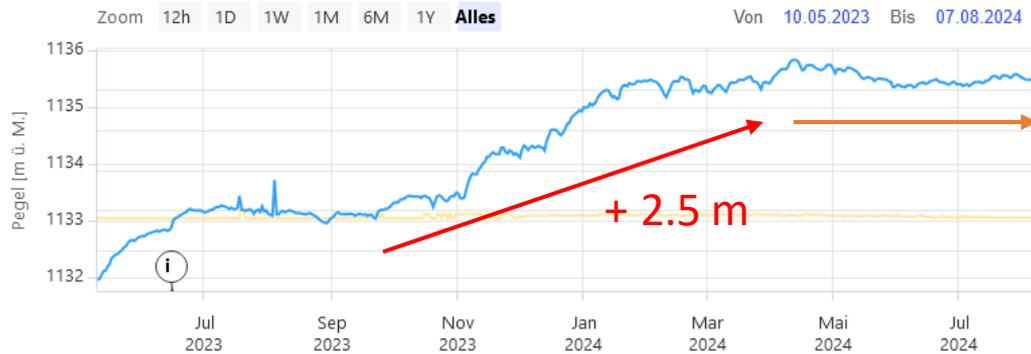
**Wasserdruckanstieg** in der Rutschmasse zwischen September 2023 bis April 2024 (Zufluss > Abfluss)
