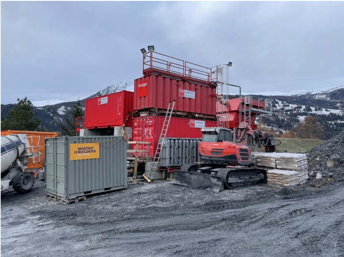
*Die Wasser-Aufbereitungsanlage beim Portal des Sondierstollens Brienz. Sie ist speziell auf die Bedürfnisse beim Tunnelbau ausgelegt. (Bild: [ecowert](#))*
