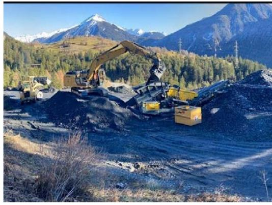
*Nach 200 Metern wurde die erste Nische ausgebrochen. Das Ausbruchsmaterial wird auf der Deponie Crappa Naira aufbereitet. (Bilder: Tiefbauamt Graubünden | Ivan Degiacomi)*
