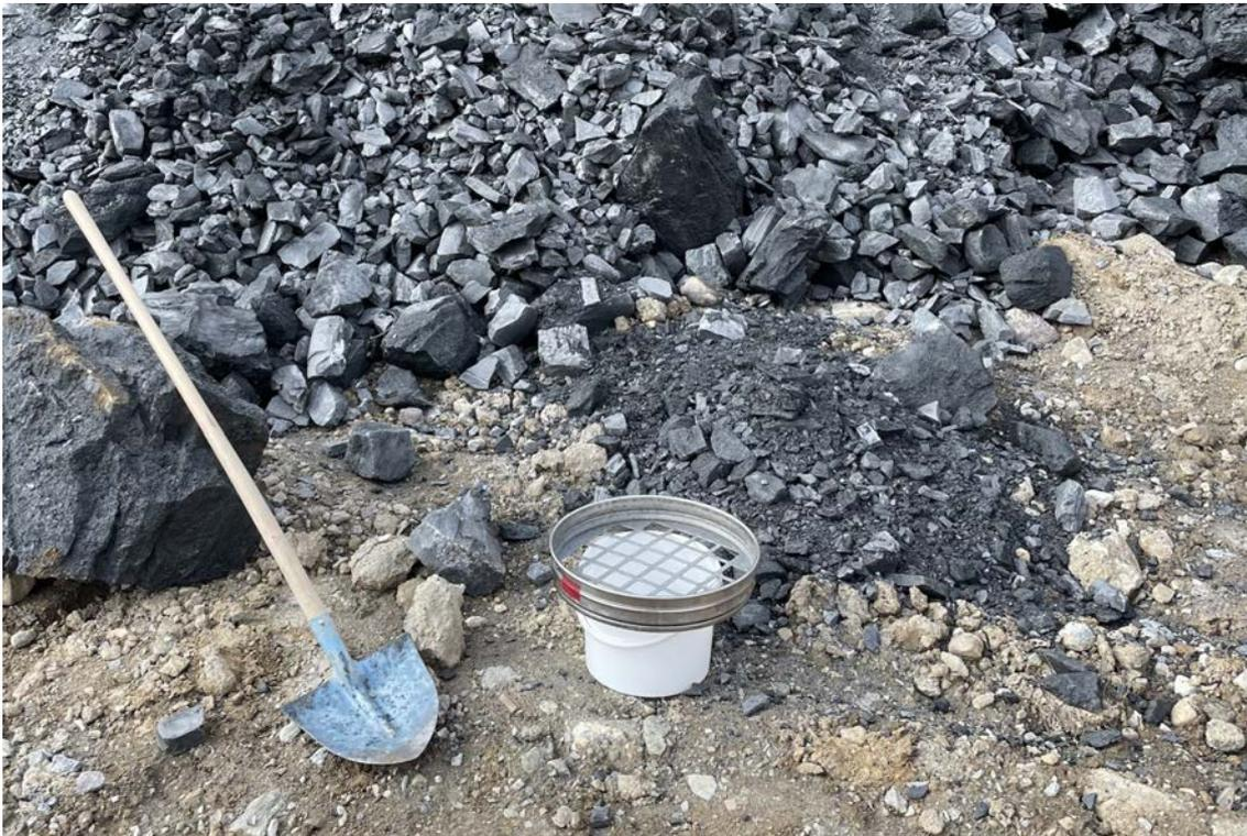
*Vom Ausbruchmaterial werden Sammelproben genommen und in einem externen Labor auf Rückstände untersucht. Bild: ecowert*
