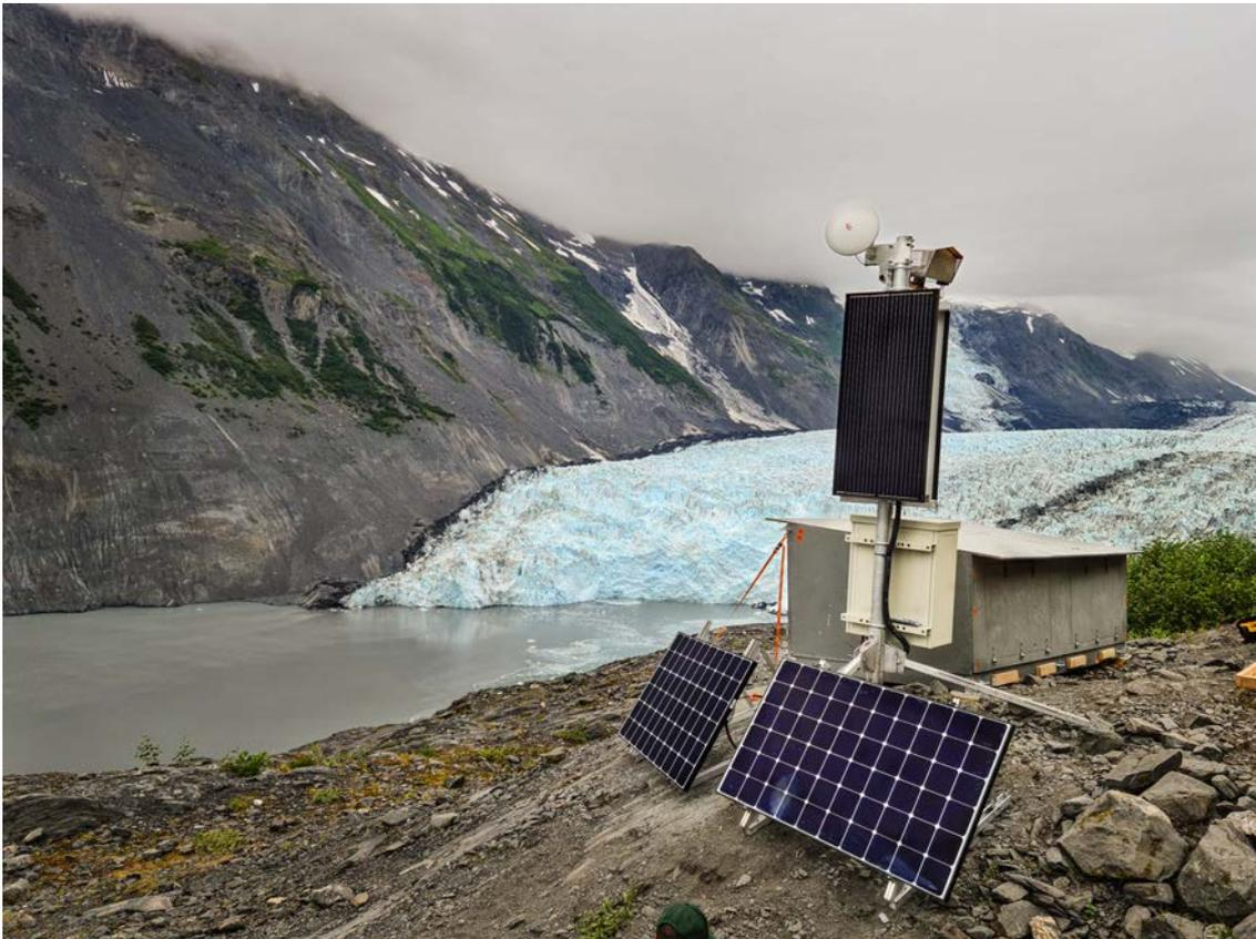
*Ein interferometrisches Radar überwacht einen Berghang beim Barry Gletscher am Golf von Alaska. Durch das Zurückschmelzen des Gletschers können Berghänge instabil werden. Wenn grosse Mengen Hangmaterial in die Meeresbucht gleiten, können sie Flutwellen auslösen. Das Radar überwacht den Berghang millimetergenau und erlaubt eine Frühwarnung für den Fall, dass der Hang abzugleiten droht. (Bild: [Geopraevent AG](#))*
