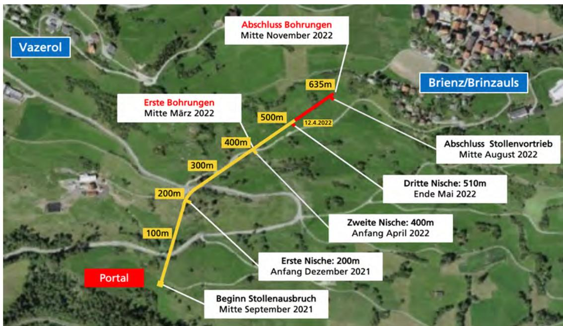
In der ersten Märzhälfte konnte ab der zweiten Stollennische eine Überwachungsbohrung ausgeführt werden. Diese Kernbohrung gibt weitere Auskunft über die Felsbeschaffenheit in der unmittelbaren Umgebung des Stollens. Sie wurde mit verschiedenen Instrumenten ausgerüstet, um die Wirkung des Stollens auf seine Umgebung zu dokumentieren.
