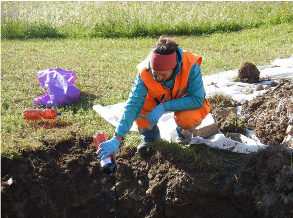
*Untersuchungen zum Wasser in der Rutschmasse bildeten einen Schwerpunkt der Forschung rund um den Brienzer Rutsch. Unter anderem wurden Farbstoffe in den Untergrund eingebracht, um Wasserläufe zu analysieren. Im Bild: Flurina Brunold bei einem Färbeversuch im Sommer 2020. Foto: BTG Büro für Technische Geologie*
