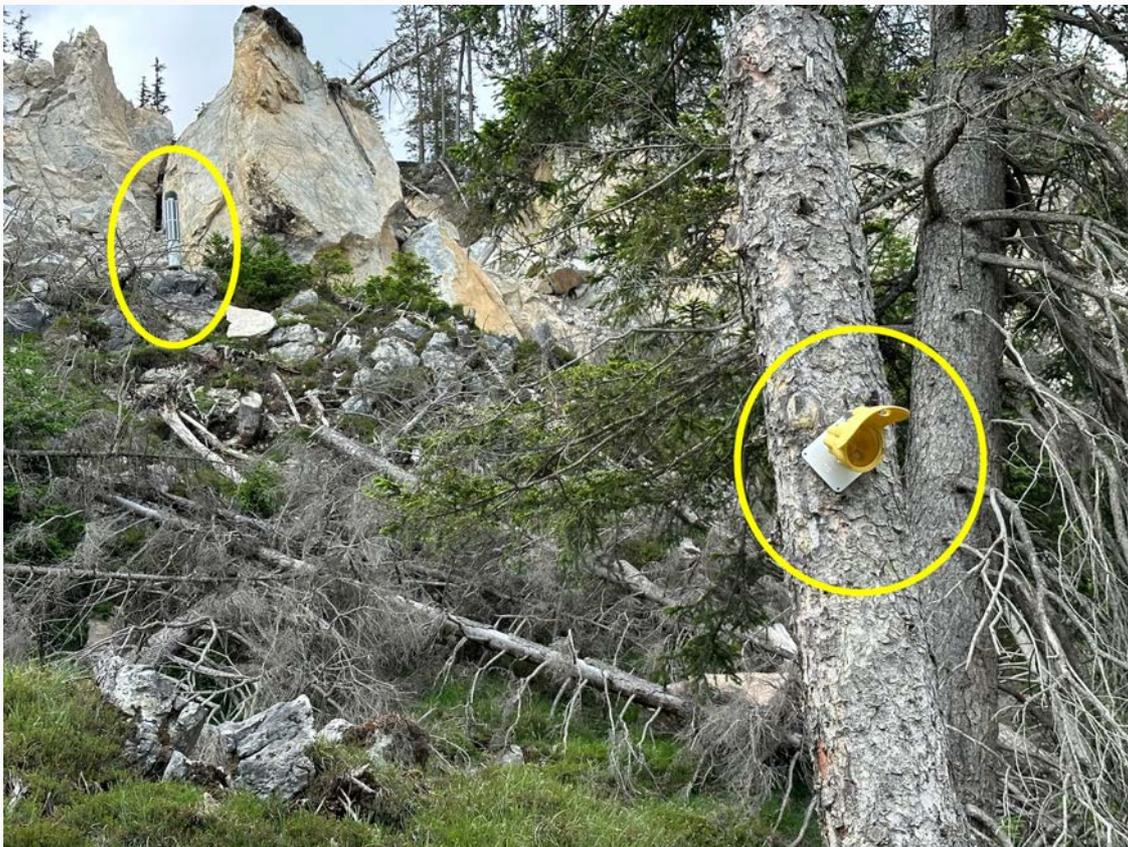
*Der Bereich «Plateau» wird durch drei unabhängige Messsysteme überwacht. Im Bild eine GPS-Station (gelber Kreis links) und ein Reflektorspiegel für den Laser-Tachymeter (rechts). Dazu kommt der Georadar am Gegenhang.*
