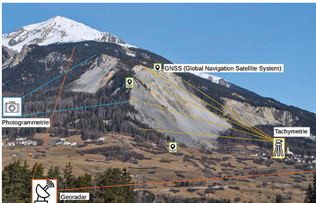
Abb. 2: Übersicht über die vier Messsysteme des Frühwarndienstes. Nicht dargestellt sind das Dopplerradar und die manuellen GPS-Messungen. Diese werden nicht direkt für die Frühwarnung benutzt, liefern jedoch zusätzliche Informationen zur Geschwindigkeitsverteilung auf der Rutschung und der Steinschlagaktivität. (Illustration: CSD INGENIEURE AG)
