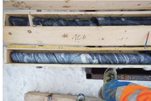
Abb. 3b: Bohrkerne aus der Sondierbohrung KB1/18 im Dorf Brienz mit dem stabilen, anstehenden Fels unterhalb der Rutschung in 202 m Tiefe. (Bild: BTG AG)
