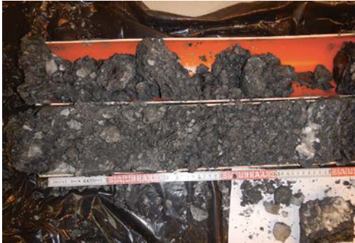
Abb. 3a: Bohrkerne aus der Sondierbohrung KB1/18 im Dorf Brienz mit dem zu einem Lockergestein zerriebenen Rutschhorizont in 152 m Tiefe. (Bild: BTG AG)
