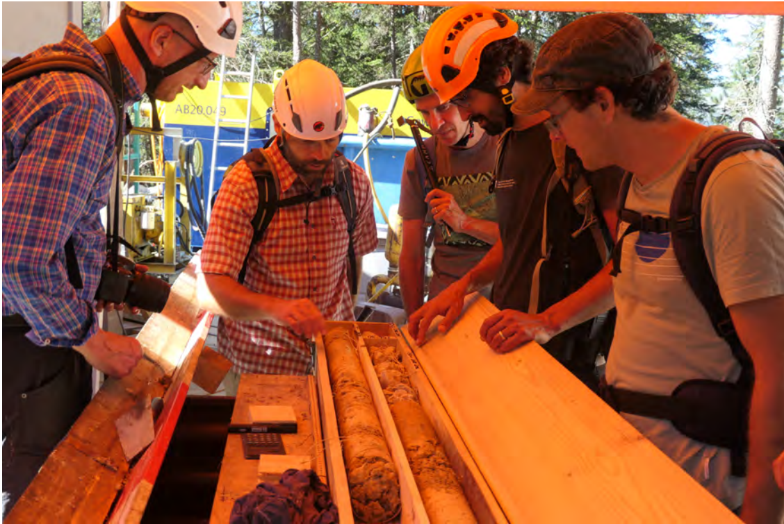
Analyse eines Bohrkerns: Thomas Breitenmoser (2. von links) mit Kollegen bei einer der Bohrungen auf der Rutschung Berg.
